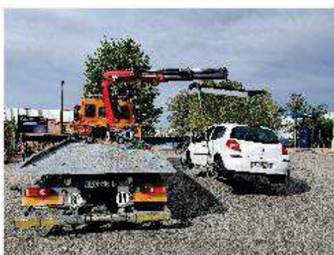
chargement grue avec griffes de roues
